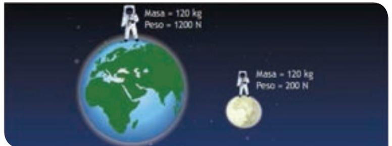
Ejemplo de la diferencia entre masa y peso de un cuerpo con la fuerza de atracción de la Tierra y la Luna.
