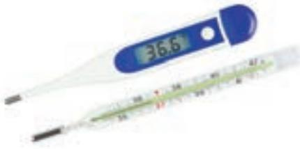
Los termómetros son un ejemplo de medición indirecta, pues miden la dilatación del mercurio, no la energía cinética del objeto en el que se coloque.
