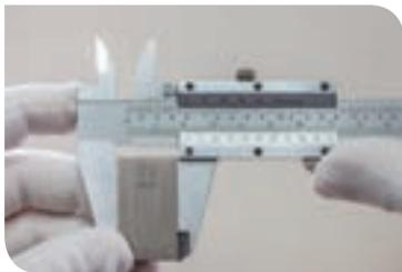
Instrumento de medición Vernier.
