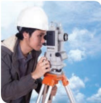
El taquímetro es un instrumento de medición usado en la topografía para medir sobre un terreno los ángulos verticales y horizontales y las distancias entre sus vértices.
