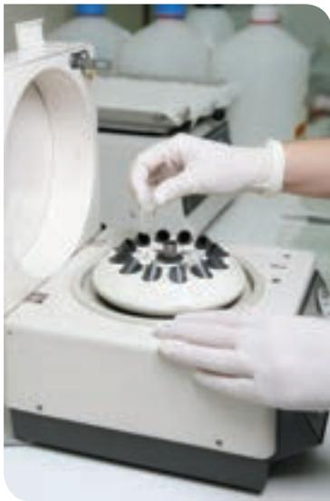
Las centrifugadoras utilizan el principio de la aceleración centrípeta para separar los componentes de una sustancia que, posteriormente, se sedimenta por la gravedad.
